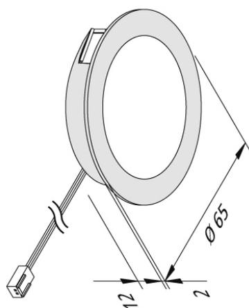
bei Dämmung Abstandshalter min. 50 mm verwenden
