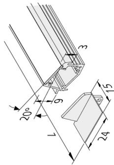
LED Einfräsprofil A 24mm
