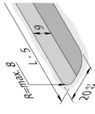
LED Einfräsprofil 24mm
