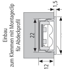
Einbau zum Klemmen mit Montageclip für Abdeckprofil
