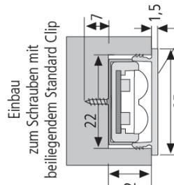
Einbau zum Schrauben mit beliebigem Standard Clip
